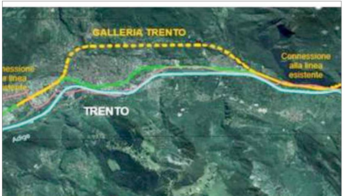
Il tracciato in galleria della circonvallazione ferroviaria ad alta capacità all'altezza di Trento sarà lungo 12,5 chilometri
